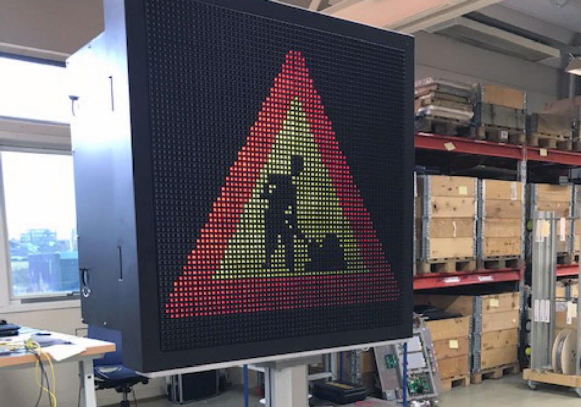
Testing av toppmontert fullgrafisk LED- skilt
