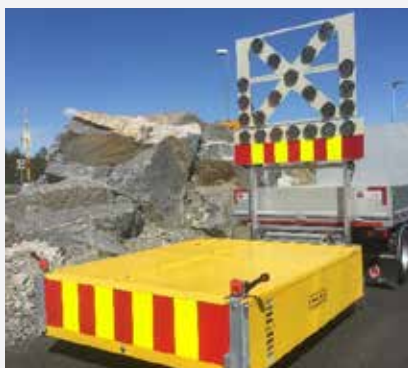
100K Julietta TMA bilmontert støtpute med varselpanel.
