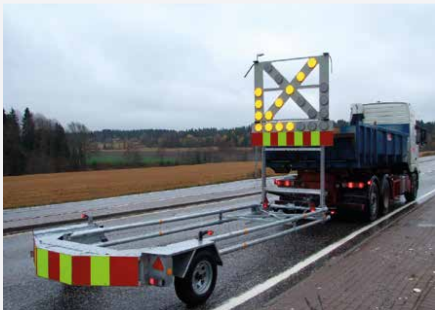
Vorteq TMA støtpetehenger med varselpanel kobles til hengerfeste og omgjør lastebilen til en TMA støtputebil.
