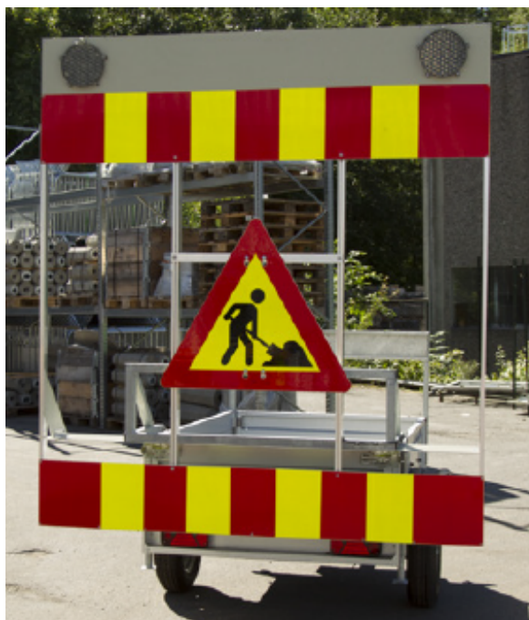
Varslingsvogn med vekselblink 1,6 m og 2 m bredde
